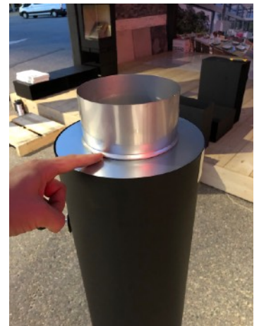
Mikäli kyseessä on vuolukivi takka, on huomioitava että liitoskappale tulee kantaa sisäputkesta, jolloin tukilevy asennetaan liitosyhteen sauman yläpuolelle.
